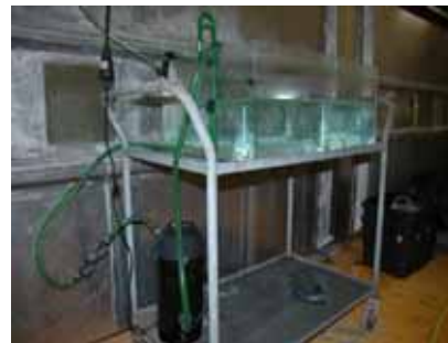
Bac de stabulation où l'eau circule en circuit fermé au travers d'un filtre de marque EHEIM
