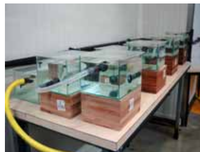
Unité de décontamination alimentée en eau de mer courante montée en série
