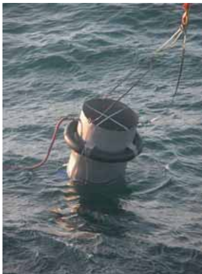
Déversement d'une nappe par cylindre flottant
