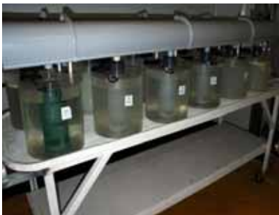
Banc écotox constitué de 12 unités comprenant un système d'agitation
