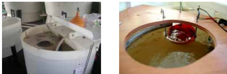
Détail d'un bac d'exposition muni du système d'écémage destiné à remettre en continu le pétrole en suspension
