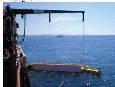
Déploiement d'un des bras récupérateur du navire antipollution Santa Maria (Source: AESM)
