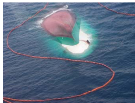
15 juillet : L'épave entourée de barrages (Source : Cedre)
