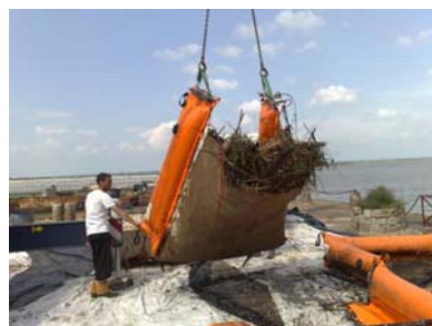
Grutage d'un chalut Thomsea utilisé à poste fixe sur un appontement : collecte de roseaux pollués (Source : Thomsea)
