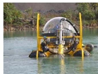
Vue du submersible portant tête d'aspiration + pompe (Source : MPC)
