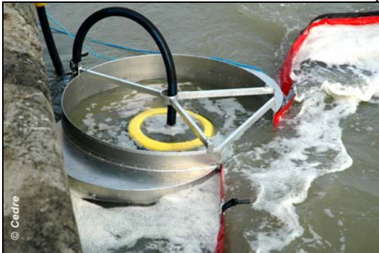
Récupérateur à seuil circus positionné au fond de la poche formée par le barrage le long de la rive (source : Cedre)
