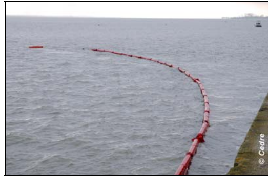
Mise en œuvre du paravane (source : Cedre)
