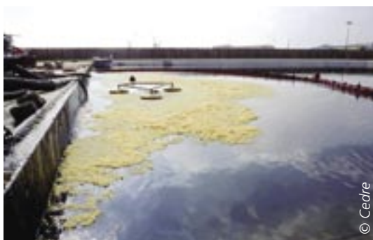
Utilisation d'absorbants en vrac, en finition après une opération de récupération mécanique. Tapis d'eau en protection de quai et récupérateur à seuil circulaire.
