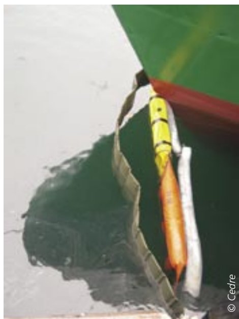
Barrage barrière (gris), barrage rideau à flottabilité permanente (orange), rideau autogonflable (jaune), barrage absorbant (boudins blancs).
