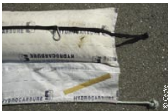
Barrage boudin avec jupe lestée et dispositif d'accrochage bout à bout pour chevauchement.
