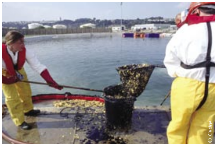
Récupération de fioul lourd sur plan d'eau à l'aide d'absorbants en vrac et d'épuisettes au cours d'un exercice sur le plateau technique du Cedre.
