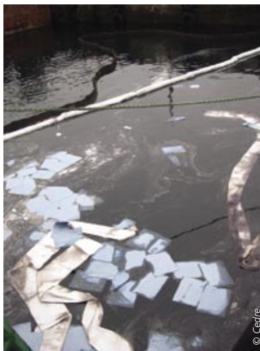
Absorbants en feuilles (carrés bleus), en rouleaux (bandes blanches), en boudins (boudins blancs).
