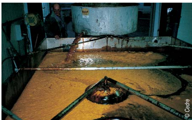
Récupérateur à seuil et huile de palme
