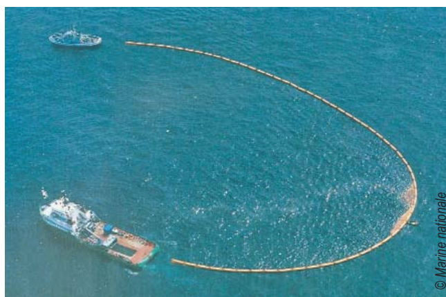
Confinement d'huile de soja (2 m 3 ) 300 m de barrage remorqués en U (expérimentation Palmor II)
