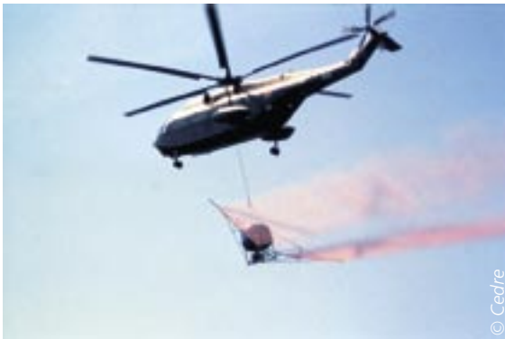
Hélicoptère lourd Super Frelon équipé d'un système Bucket SOKAF en traitement
