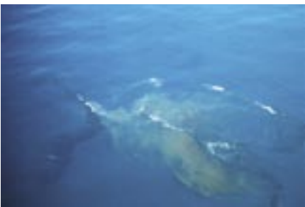
7, 8 - Vue d'un aéronef, aspect des nuages de pétrole dispersé (de couleur beige) qui se distingue bien de l'hydrocarbure en surface (de couleur noire). Noter sur la photo 7 la présence de mousse blanche qui témoigne d'un excès de dispersant.
