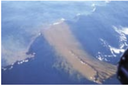
4 - Au passage de la vague sur la nappe traitée, le pétrole se met en suspension : apparition du nuage beige.
