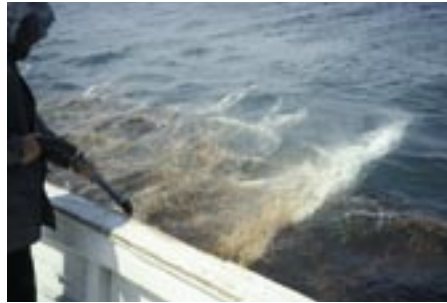
1, 2 - Essai de dispersion. Noter l'apparition de façon ponctuelle de la coloration beige au niveau de la nappe juste après le traitement, et de façon soutenue après l'agitation réalisée à la lance incendie.
