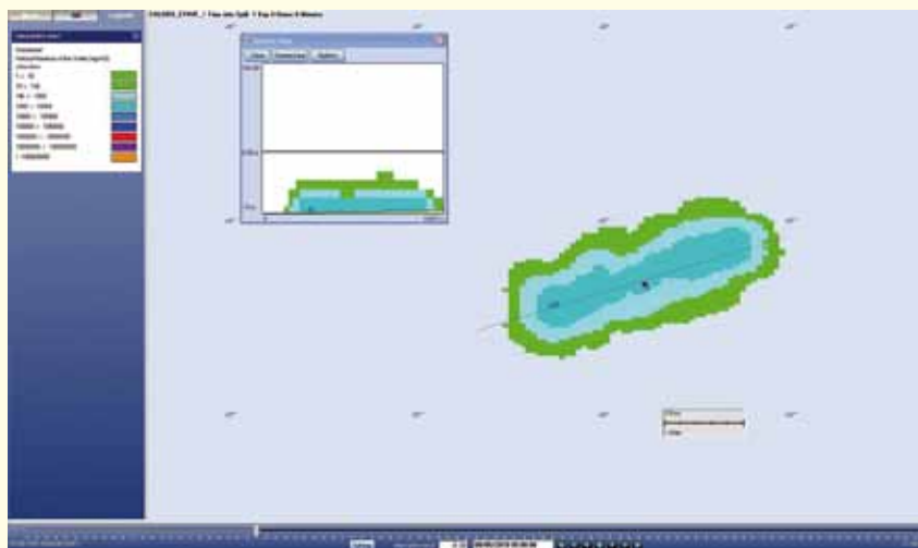
Figure 2 : fuite de chloroforme à partir d'une épave. Vue aérienne du fond et en coupe pour l'encart. Les couleurs bleu foncé et bleu clair correspondent à la PEC/PNEC >1. La zone impactée s'étend sur une distance de 20 km dans l'axe SO-NE et 7 km dans l'axe perpendiculaire.
