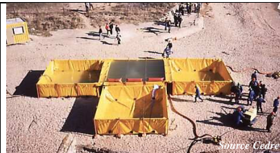
Bacs de décantation continue (4 bacs de 35m 3 )
