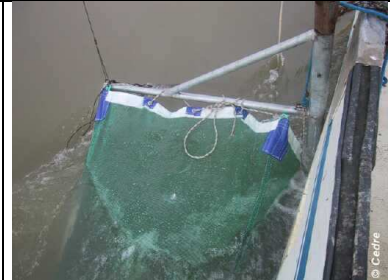
Gros plan sur un pibalour (filet destiné à la pêche à la civelle), utilisé ici pour la récupération de boulettes d'hydrocarbures en frange littorale.
