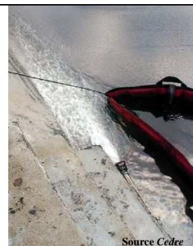
Etanchéité assurée par un contre-courant créée à l'aide d'un jet d'eau
